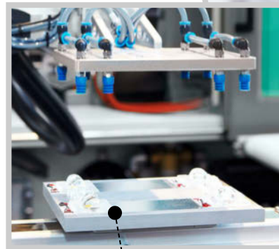
Pièces optiques : reproductibilité élevée grâce à des entraînements servoélectriques.
