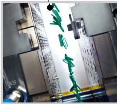
Pièces optiques : reproductibilité élevée grâce à des entraînements servoélectriques.
