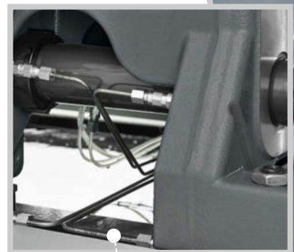
Entretien aisé : lubrification centrale automatique de l'unité de fermeture.
