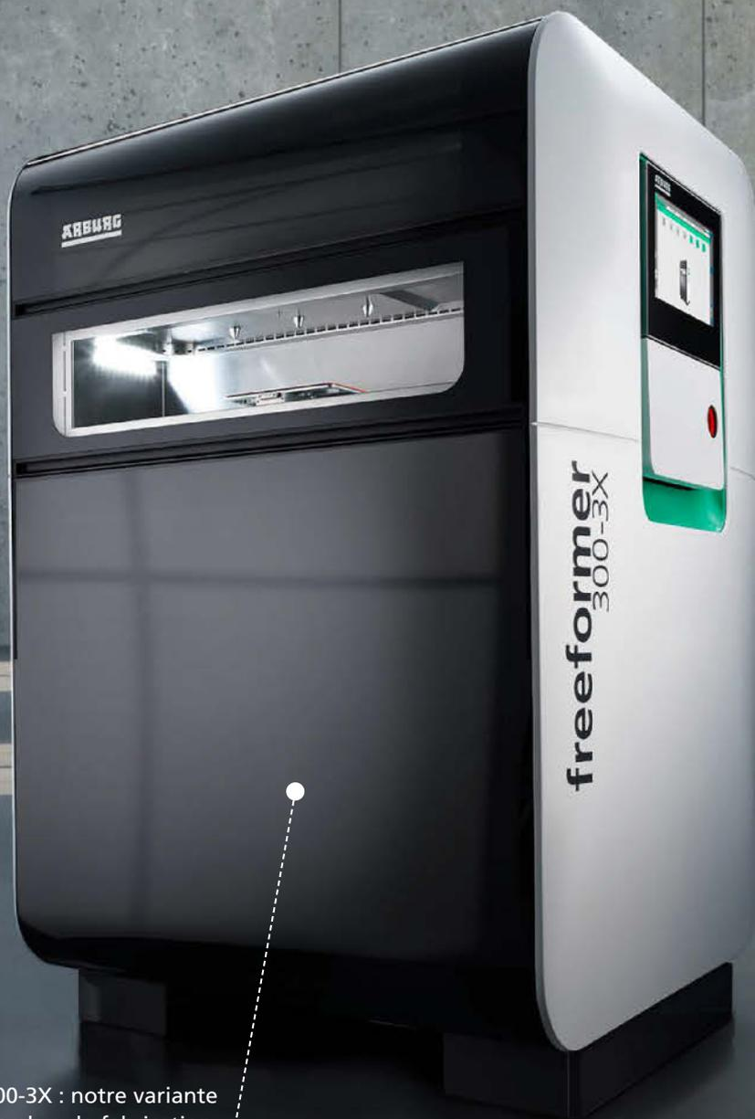
freeformer 300-3X : notre variante offrant une chambre de fabrication 50 % plus grande et avec jusqu'à trois unités de décharge.
