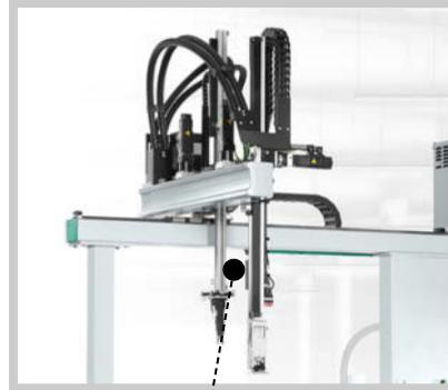
Variante : MULTILIFT SELECT 6+1 avec deux axes plongeants verticaux – idéal pour les moules à 3 plateaux.
