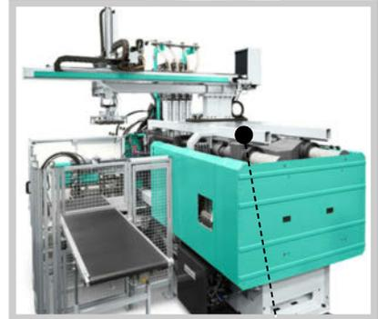
Installation au-dessus du plateau mobile de bridage du moule : adaptée à l'unité d'injection verticale.
