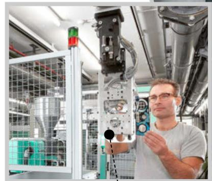
Retrait du côté opérateur : intégration d'opérations manuelles, telles que le contrôle de la qualité des pièces injectées.
