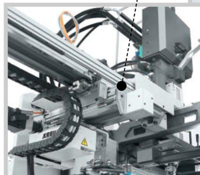
Variante : MULTILIFT H 3+1 avec deux axes d'intervention à l'horizontale, prédestiné pour la micro-injection.
