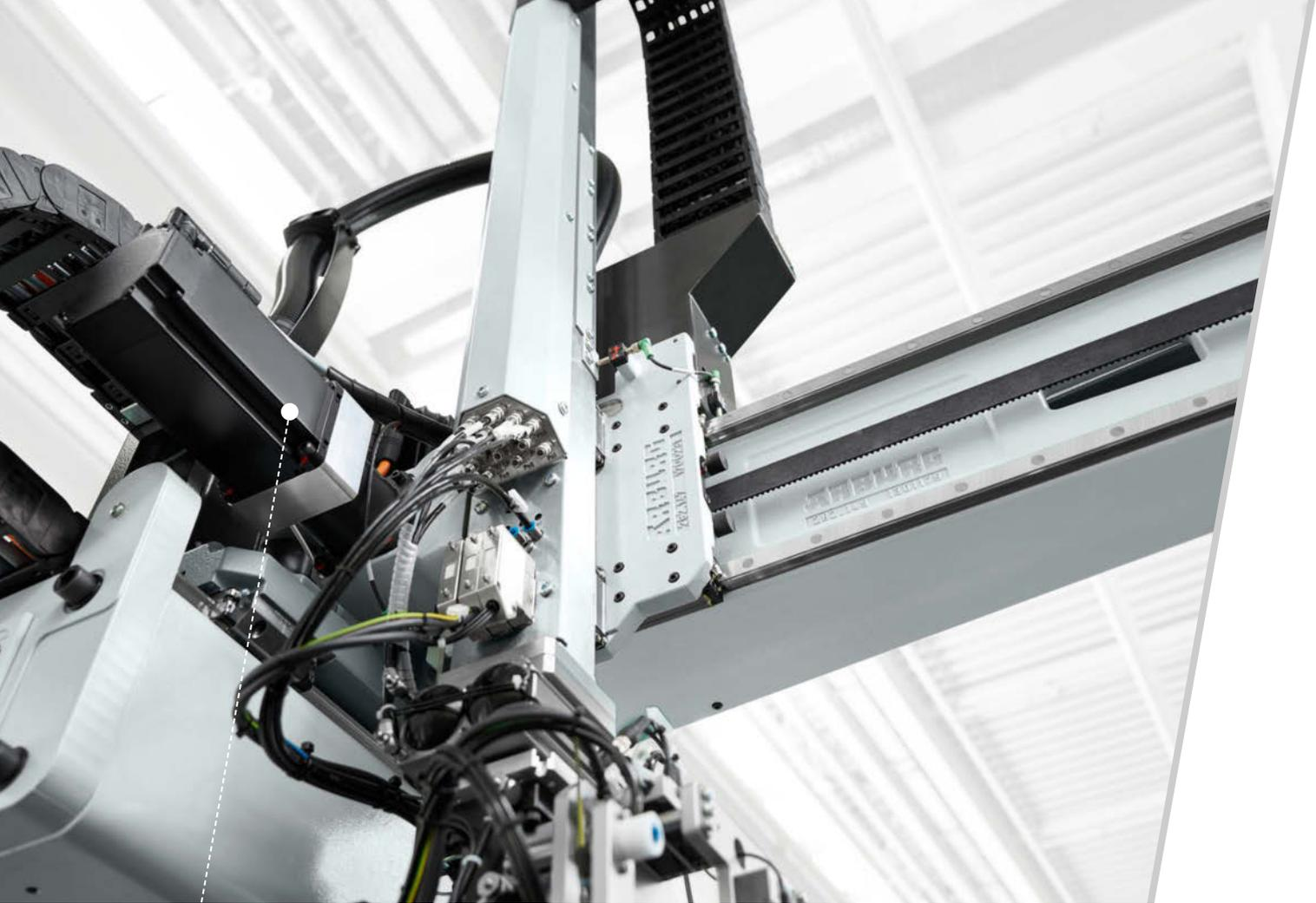
Technique d'entraînement haut de gamme : mouvements simultanés, rapides et précis au moyen de servomoteurs dotés de régulateurs séparés.
