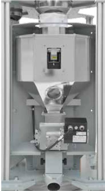
Vis de dosage de précision montée d'un côté avec fermeture à baïonnette
